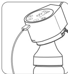
1. С усилием вставьте коннектор USB Type-C до упора в разъем подзарядки прибора, расположенный на задней стороне электронного блока.
